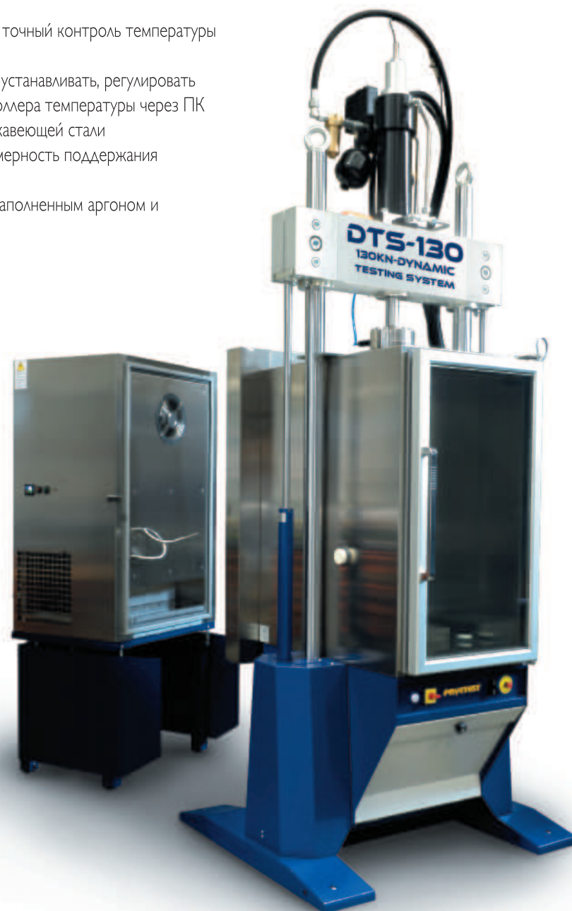
Испытательная камера с термостатирующим блоком
