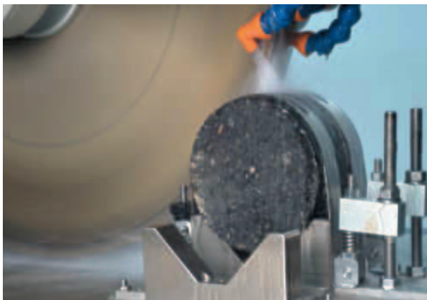
Резка керна (цилиндра) двумя дисками одновременно
