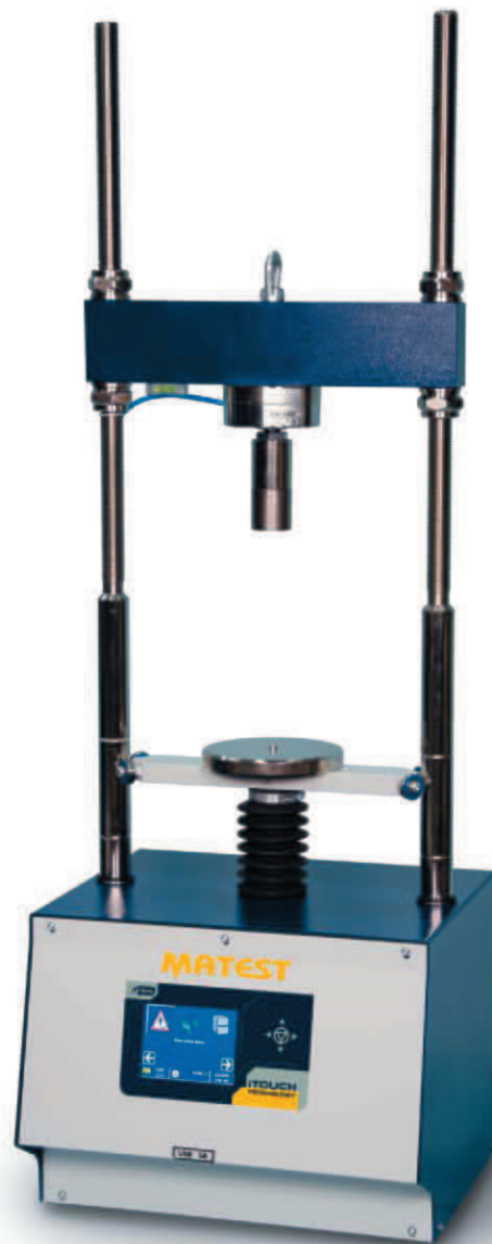
S205M с датчиком нагружения
