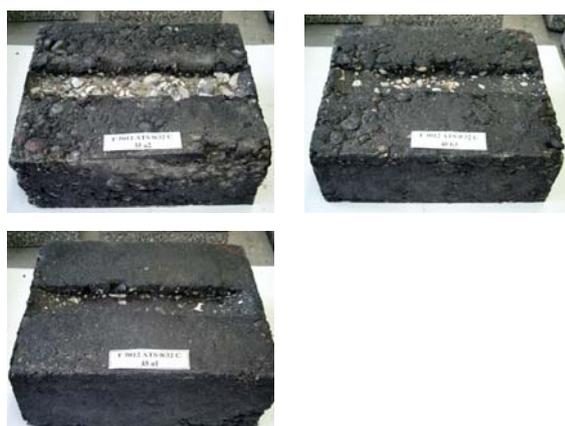
**Abbildung 35:** Spurrinne, ATS 0/32 C mit 3,5; 4,0; 4,5 M % Bindemittel im Mischgut
