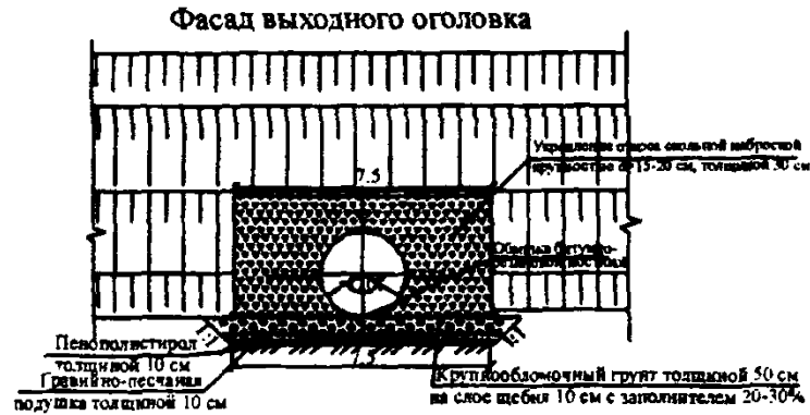
Рис. М.2 . Пример проектирования армогрунтовой обоймы, противофильтрационного экрана (геомембраны), входного и выходного оголовка и рассеивающего валика для МГТ на рис. М.1
