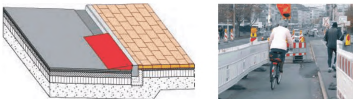
Рисунок 59– Пример обустройства короткого пандуса на временном пешеходном пути
