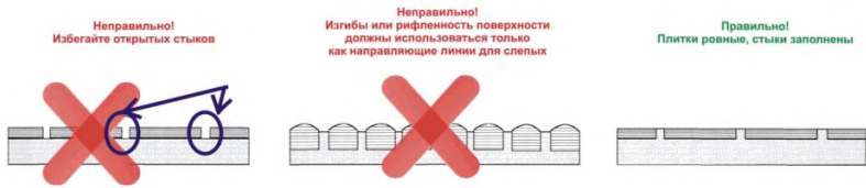
Рисунок 1 – Неправильная и правильная формы поверхности покрытия пешеходной части элементов обустройства автомобильных дорог
