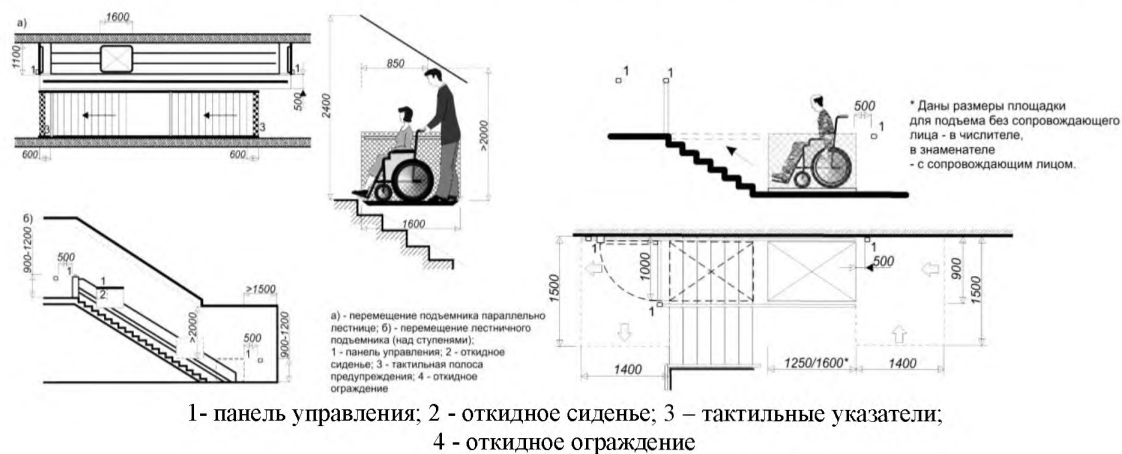
а) Подъемник наклонного типа для инвалида с сопровождающим лицом
