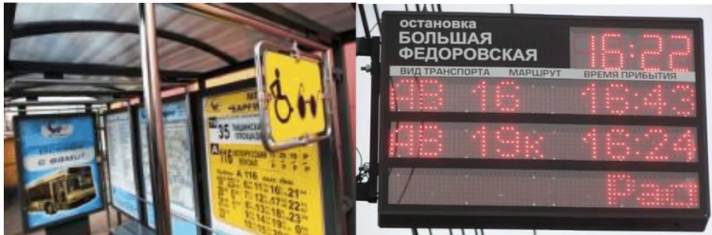
Рисунок 52 – Пример информационной таблички и электронного табло на остановочном пункте
