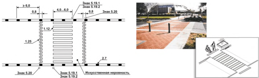
Рисунок 18 – Примеры проектных решений наземных нерегулируемых пешеходных переходов, приподнятых над поверхностью проезжей части автомобильной дороги
