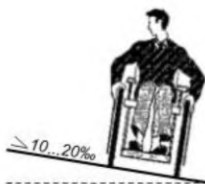
Рисунок 5 – Максимально допустимые значения поперечного уклона
