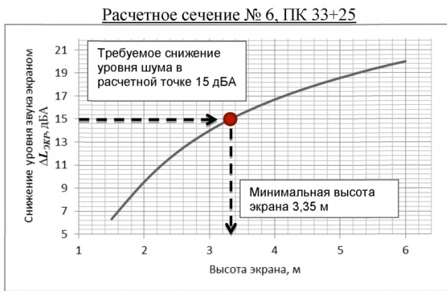
Рисунок Г.1 –Пример графического определения минимальной высоты экрана в расчетных сечениях с использованием зависимости «высота - экранирующий эффект сооружения»
