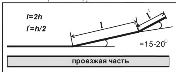
Рисунок 11.27 - Схема назначения параметров начального (конечного) участка
