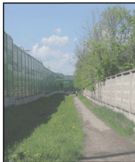
Рисунок 12.3 - Высокий шумозащитный экран создающий «тоннельный эффект» со стороны дороги и «эффект тюрьмы» со стороны застройки
