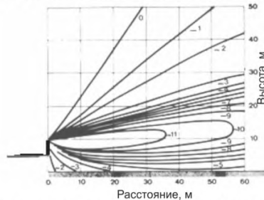
Рисунок В.2 - Снижение эквивалентных уровней транспортного шума на территории, прилегающей к проектируемому участку четырехполосной дороги, в зависимости от высоты экрана и поперечного профиля (цифры на кривых – снижение эквивалентных уровней транспортного шума, дБА)
