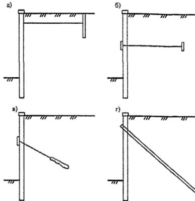
а – анкерное крепление в виде анкерной стены или небольшой свайной стенки; б – то же, через железобетонный анкерный куб или анкерную плиту; в – крепление с помощью преднапряженного грунтового анкера; г – то же, с использованием наклонных микросвай
