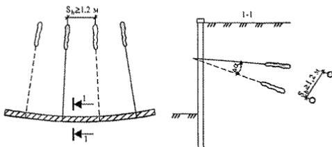
Рисунок 21 – Расположение анкеров на криволинейных участках сооружения
