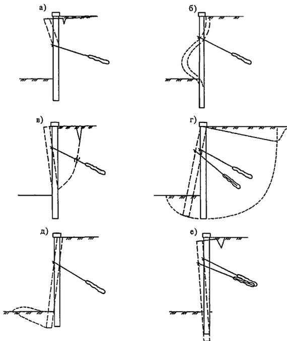
а – разрушение консоли над анкерами; б – прогиб в средней части стены; в – обрыв (деформация) тяги; г – потеря общей внешней устойчивости сооружения; д – разрушение основания в заделке свай; е – осадка свай от вертикальной нагрузки
