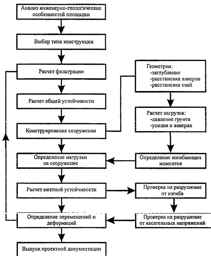
Рисунок 1 – Рекомендуемая последовательность проектирования свайно-анкерных сооружений
