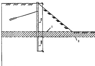
1 – линия подрезки участка склона после устройства удерживающей конструкции; 2 – слабый грунт;
