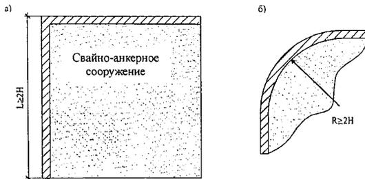
$H$  – высота удерживаемого массива грунта, м;  $L$  – протяженность сооружения, м;  $R$  – радиус поворота сооружения, м
