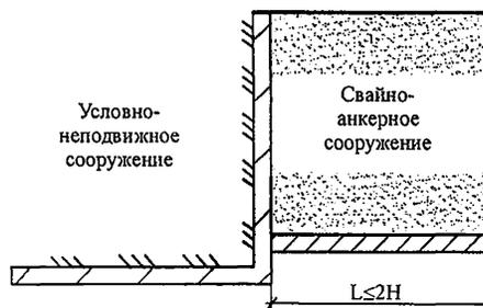
Рисунок 8 – Примыкание к существующему сооружению
