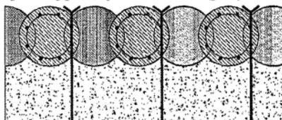
Рисунок 13 – Сопряжение через стык рабочей и забирочной сваи
