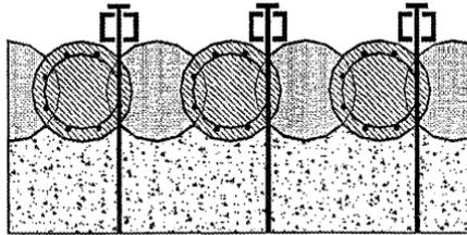
Рисунок 15 – Сопряжение через вертикальную распределительную балку
