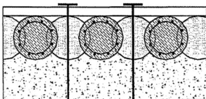
Рисунок 12 – Сопряжение через забирочную сваю
