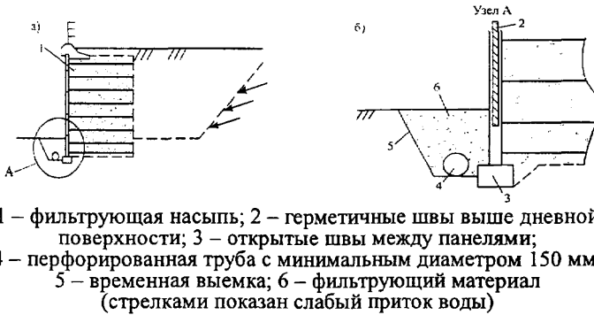
Рисунок 33 – Отвод воды из застенного пространства
