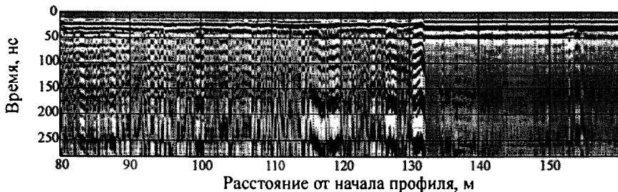
Рисунок В.3 – Пример георадиолокационного (временного) разреза
