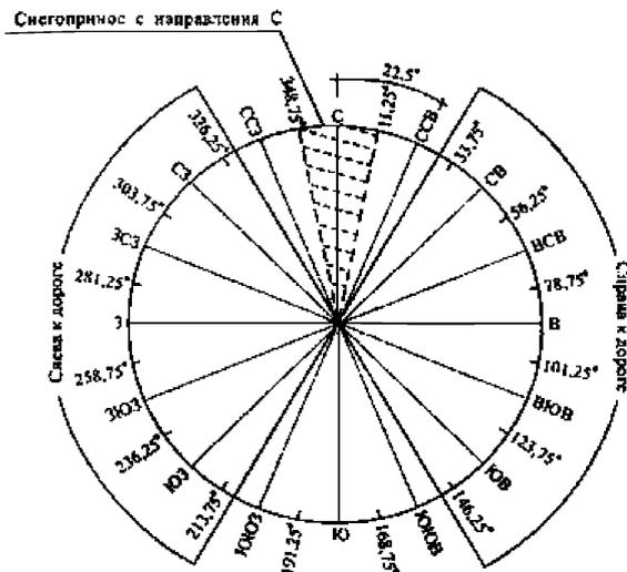
Рисунок 1 - Схема расчета объемов снегоприноса к дороге, направленной на Север
