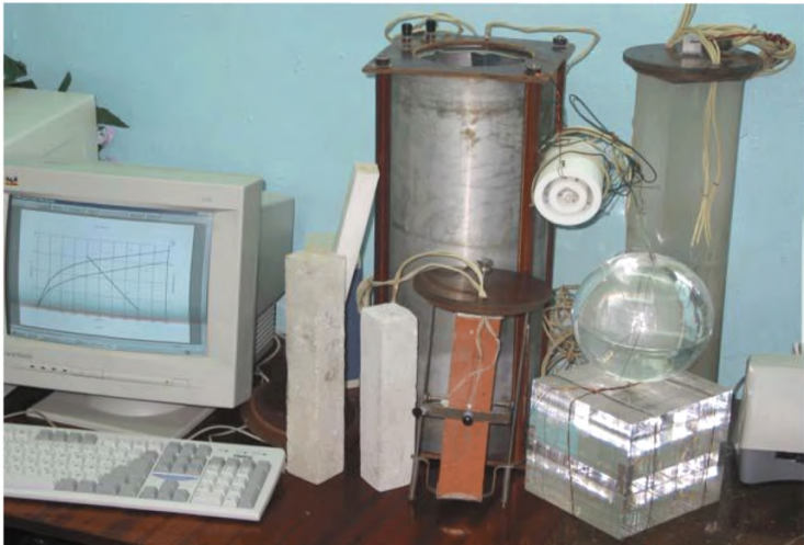
Рисунок 18 – Определение температуропроводности красного кирпича контактном методом Чернышова-Фокина
