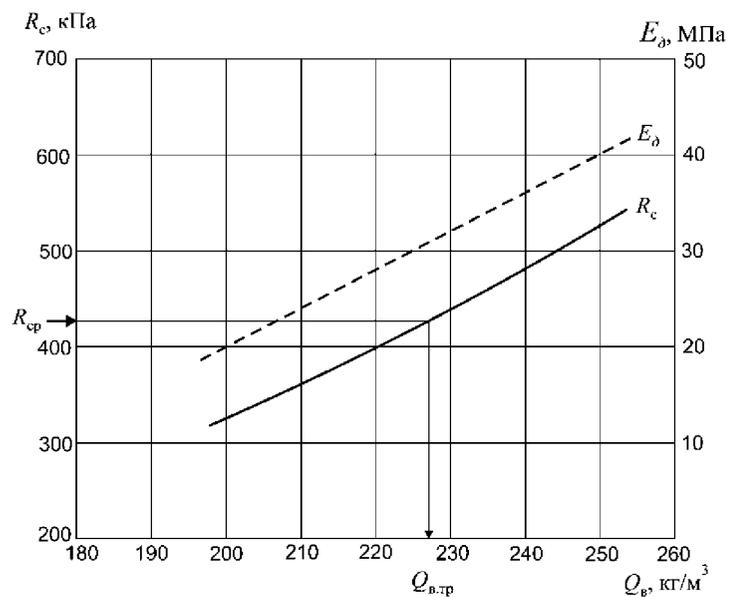
$R_c, \tau, E_\delta$  – соответственно, предел прочности, сопротивление сдвигу и модуль деформации при одноосном сжатии;  $\epsilon_0$  – относительная деформация при максимальной нагрузке;  $\epsilon_1$  – неучитываемая часть относительной деформации
