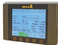
Рисунок 10 – Пример компонентов оборудования для глубинного смешивания в массиве: смеситель (а); питатель (б); система управления и регистрации основных технологических параметров (в)
