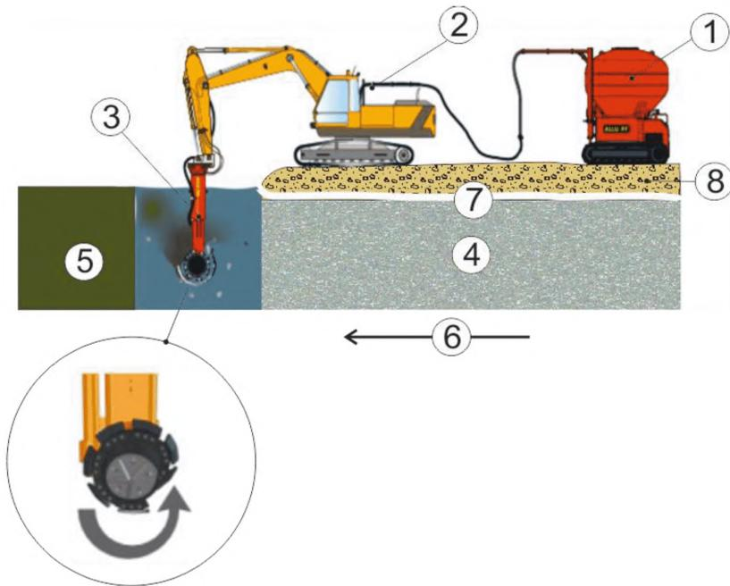
1 – питатель; 2 – базовая машина – экскаватор на гусеничном ходу; 3 – смеситель; 4 – укрепленный грунт; 5 – неукрепленный грунт; 6 – направление укрепления; 7 – геотекстильный материал; 8 – рабочая платформа (нижняя часть насыпи)
