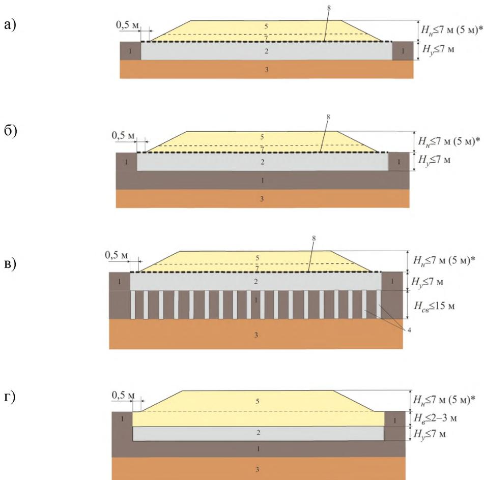
1 – слабый грунт; 2 – укрепленный слабый грунт; 3 – прочный грунт; 4 – сваи (в том числе из укрепленного грунта); 5 – земляное полотно; 6 – замена выторфованной части грунта грунтом земляного полотна; 7 – рабочий слой; 8 – геосинтетический материал
