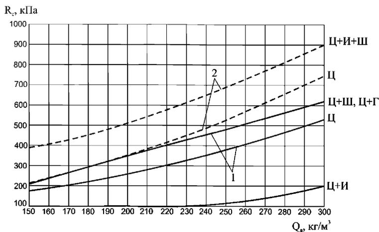
1 – торф; 2 – заторфованные органо-минеральные грунты; Ц – цемент; Ц+Ш – цемент и шлак; Ц+И – цемент и известь; Ц+Г – цемент и переувлажненный связный грунт; Ц+И+Ш – цемент, известь и шлак
