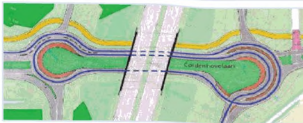
Рисунок В.3 - Схемы примыкания съездов к второстепенному направлению с использованием турбо-кольцевой организации движения [23]
