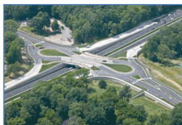
Рисунок В.1 - Кольцевая организация движения в зоне транспортных узлов на примыканиях съездов с магистральных дорог к второстепенному направлению на дорогах Франции и США [7]
