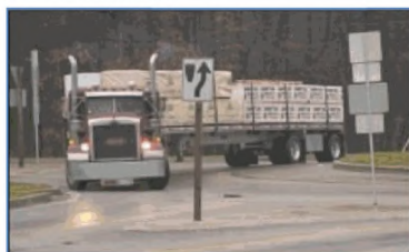
Рисунок 5.6 - Проезд кольцевых пересечений с заездом на краевую полосу центрального островка крупногабаритным грузовым автомобилем [7]
