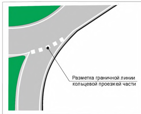
Рисунок 12.3 - Рекомендуемая разметка граничной линии кольцевой проезжей части
