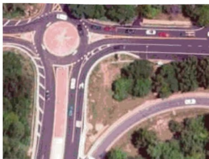
Рисунок 5.24- Планировочные решения дополнительной правоповоротной полосы кольцевых пересечений с широким разделительным островком (а, б, в) и с самостоятельной трассой правоповоротной полосы (г) [2, 7]
