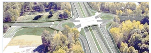
Рисунок В.3 - Схемы примыкания съездов к второстепенному направлению с использованием турбо-кольцевой организации движения [23]
