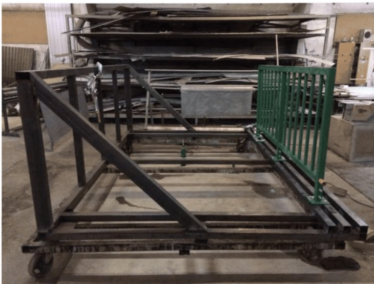
Рисунок Г.1– Площадка для испытания перильных ограждений
