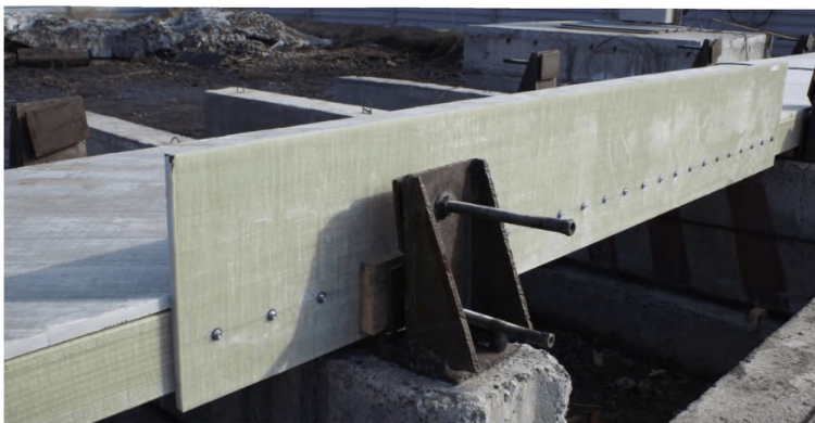
Рисунок В.5 – Упоры монтажного стола
