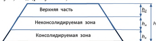
Рисунок 2 – Поперечный профиль насыпи из грунта повышенной влажности с выделением неконсолидируемой (пассивной) и консолидируемой (активной) зон
