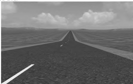
Рисунок 39 – Зрительный “провал”, характерный для коротких вертикальных вогнутых кривых, располагаемых на длинных прямых
