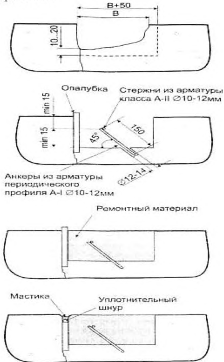
Рис.3.2. Ремонт плит со сколотыми кромками
