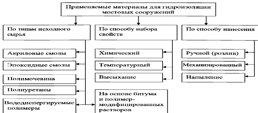
Рисунок 1 – Классификация применяемых материалов бесшовной напыляемой мостовой гидроизоляции
