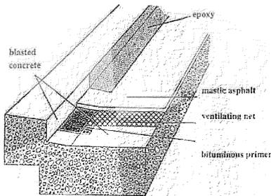
Рисунок Б.4 – Гидроизоляционная система с литым асфальтобетоном
