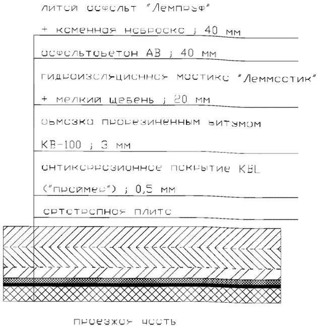
Рисунок А.1 – Конструкция дорожной одежды на ортотропной плите моста через реку Волгу у с. Пристанное в Саратовской области. После 15 лет эксплуатации (объект сдан в 2000 г.) покрытие находится в работоспособном эксплуатационно-пригодном состоянии
