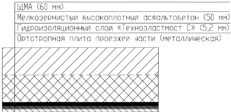
Рисунок А.10 – Конструкция одежды ездового полотна на мосту «Живописный» через р. Москву в районе Серебряного бора
