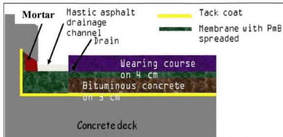
Рисунок Б.6 – Конструкция дорожной одежды с использованием комплексного решения на основе битума
