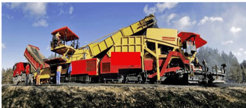
Рисунок 6 – Асфальтоукладочный комплекс для одновременной укладки двух слоев асфальтобетонного покрытия по технологии «компакт-асфальт»
