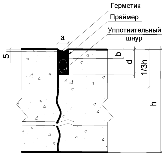
Рисунок 4 - Деформационный шов сжатия
