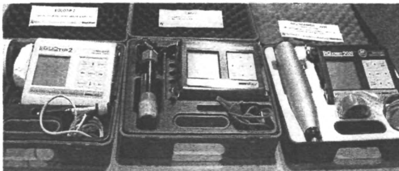
Рисунок А.6. Приборы неразрушающего контроля железобетонных конструкций: а – твердомер по металлу; б – измеритель степени коррозии арматуры; в – измеритель прочности бетона на сжатие
