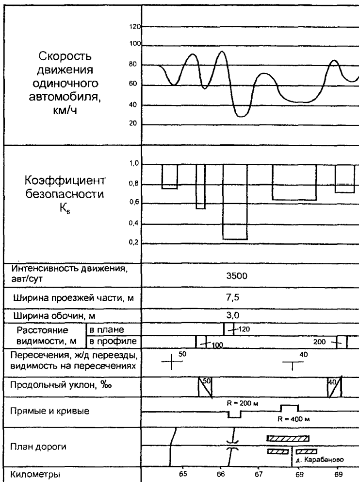
Рис. 5.1. Линейный график скоростей движения одиночных автомобилей и график коэффициентов безопасности
