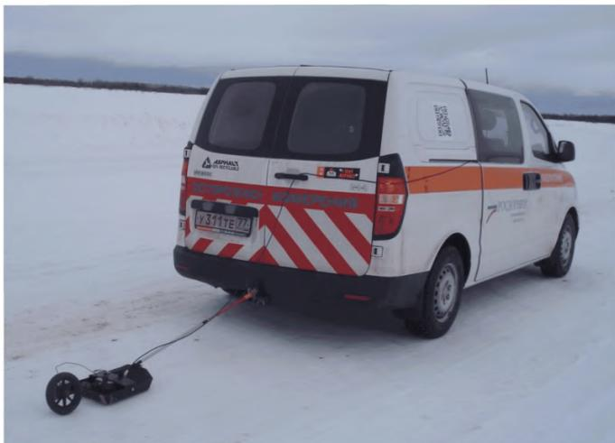
Рисунок 1 – Измерение толщины льда на ледовой переправе контактными антенными блоком АБ-1700
