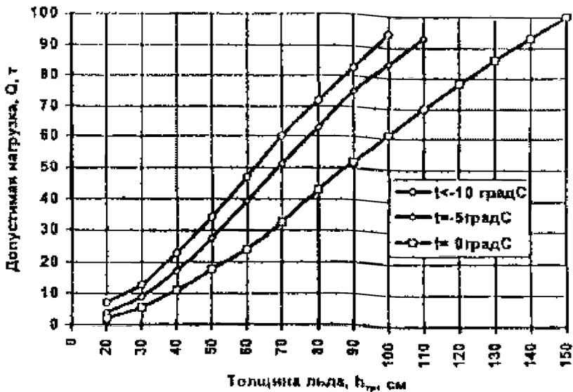
Рисунок 4 – Допустимые нагрузки на ледяной покров при пропуске по нему гусеничных транспортных средств
