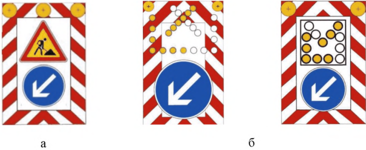
Рисунок 13 – Примеры передвижных заградительных знаков со световой индикацией: а ↑ без мигающей стрелы; б ↑ с мигающей стрелой
