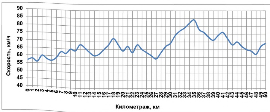
Рисунок 23 – Пример эпюры эксплуатационных скоростей движения
