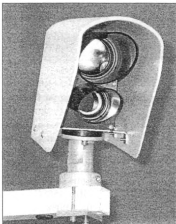
Рисунок В.1. Дистанционный датчик состояния поверхности дорожного покрытия DSC 111 (Vaisgla)
