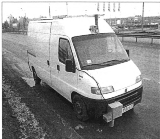
Рисунок Г.3. Передвижная лаборатория для проведения работ по термокартированию
