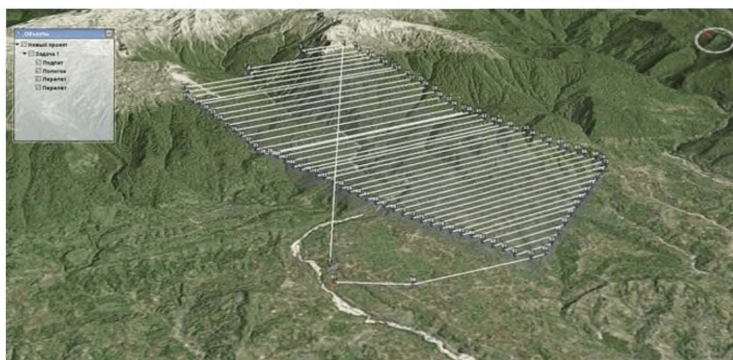
Рисунок К.1 – Расчет полетного задания в ПО GeoscanPlanner 2.1
